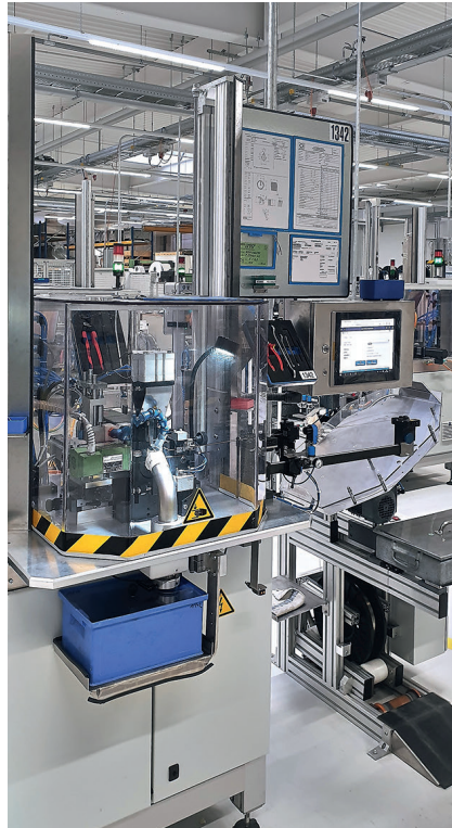
Fig. 2. Connection of a metalworking machine to the ALS system © Böllhoff
